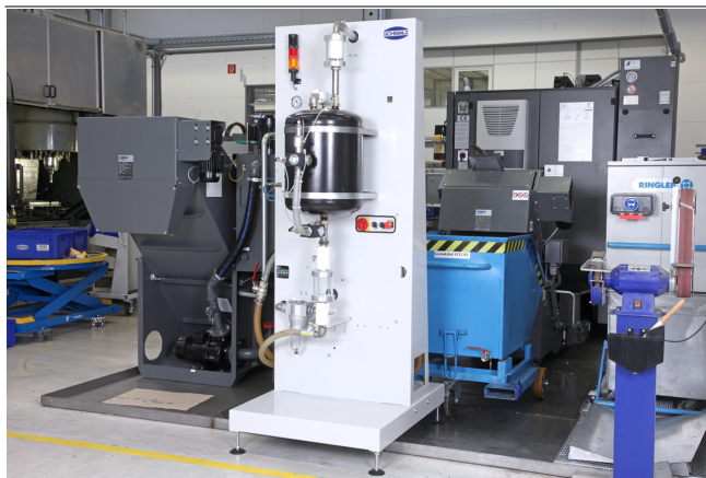
Vacuum Operation Center VOC per la generazione di vuoto in condizioni di lavoro bagnato
